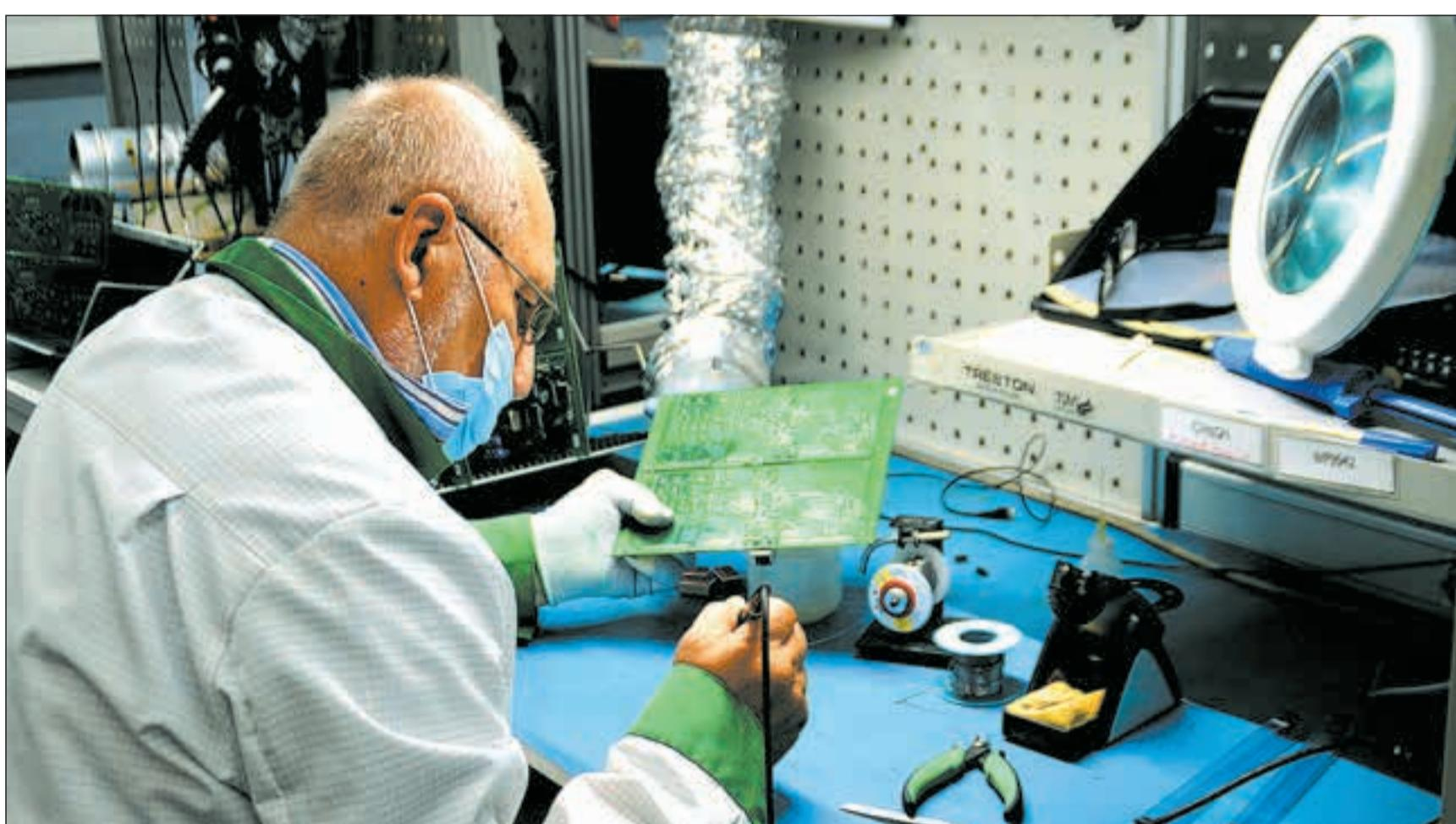
Несмотря на максимальную автоматизацию, без ручного труда при производстве электроники не обойтись.
